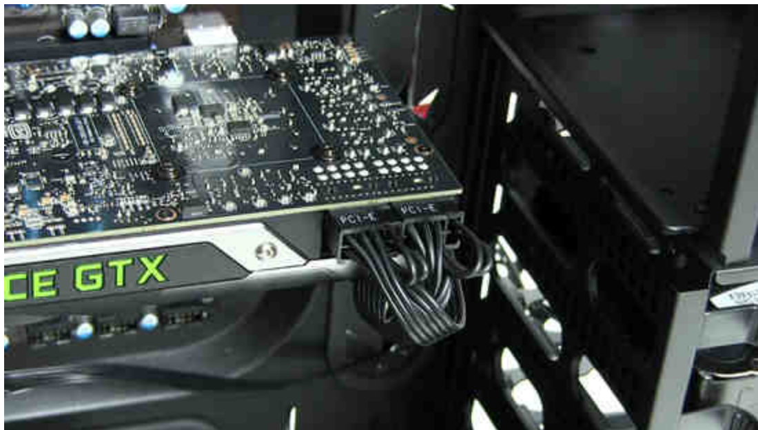
Rys. 19. Najbardziej prądożerne (ale i potężne) modele wymagają użycia dwóch wtyczek ośmiopinowych.
