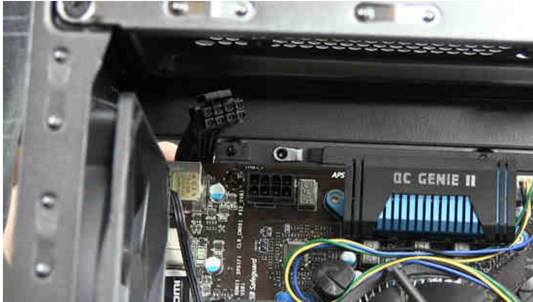
Rys. 18. Drugim kablem zasilającym procesor jest EPS, który wpinamy w gniazdo znajdujące się w lewym górnym rogu płyty.
